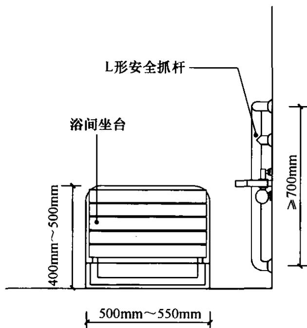
图 8 无障碍淋浴间局部平面图
