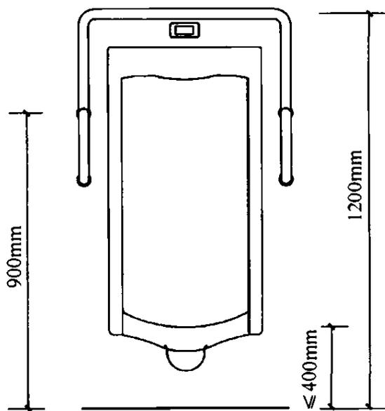
图 5 无障碍小便器安全抓杆平面图 图 6 无障碍小便器安全抓杆正立面图
